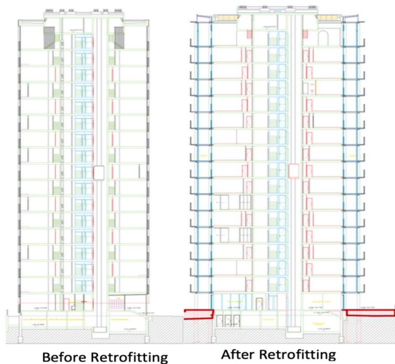
Fig. 4. Extending the plan outwards, Tour Bois le-Prêtre [26].
